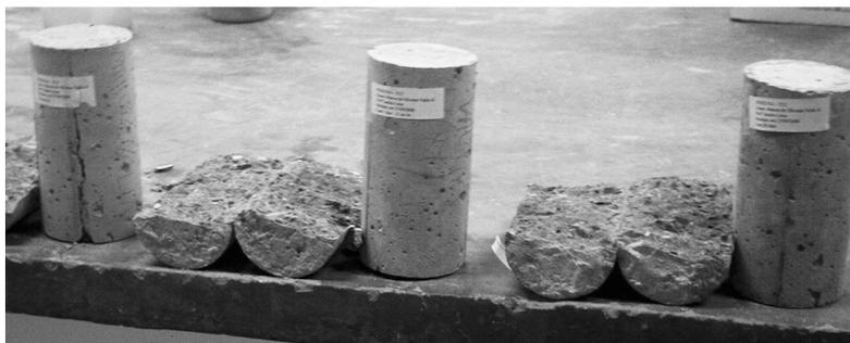
**Figura 1** – Corpos de Prova ensaiados: idade de 28 dias.
