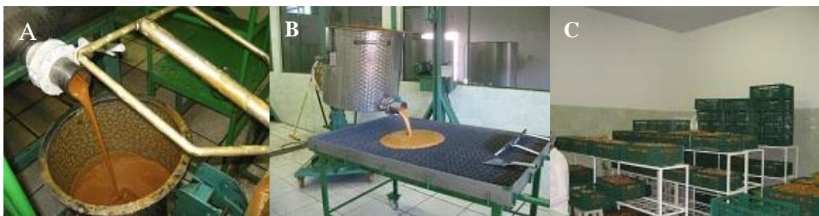
Figura 6. Resfriamento e Agitação da massa [A], moldagem da rapadura [B] e resfriamento das rapaduras [C].
