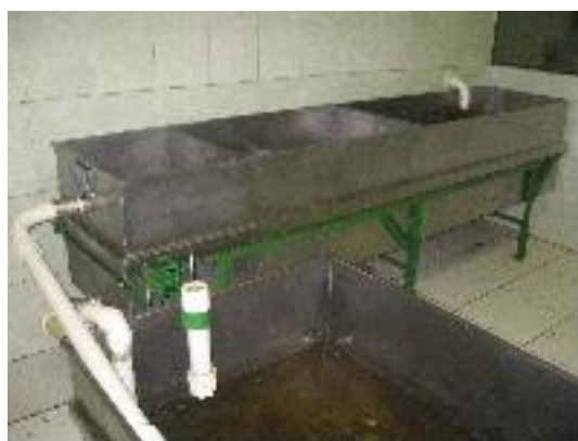
Figura 4. Decantação do caldo de cana-de-açúcar.
