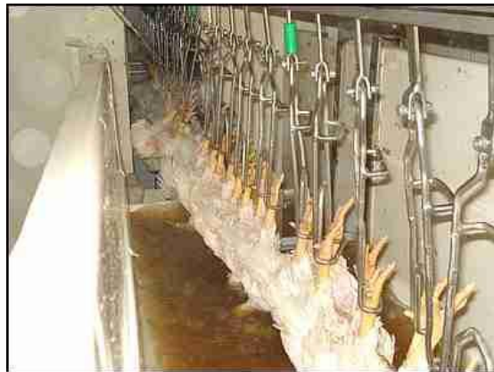
Figura 4: Insensibilização de aves por eletronarcose. Fonte: FERREIRA (2010).
