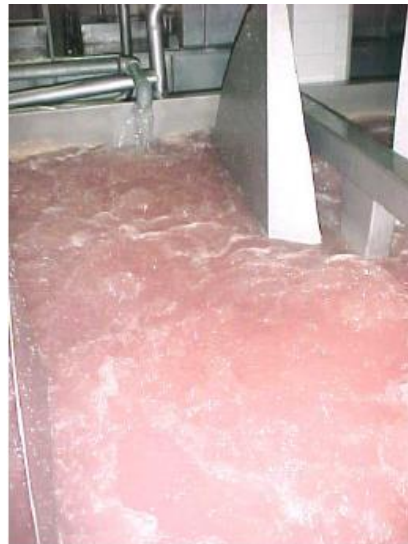
Figura 9: Chiller com borbulhamento de ar. Fonte: KLASSEN (2008).
