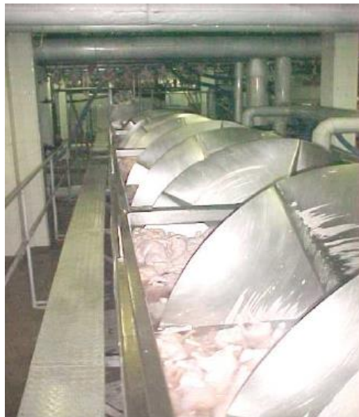
Figura 7: Pré-resfriamento por imersão em água gelada. Fonte: KLASSEN (2008).
