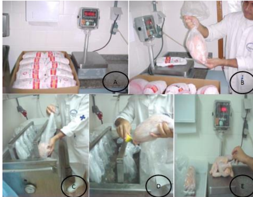
Figura 14: Drip Test – Seleção das carcaças congeladas (A); Retirada da embalagem original e pesagem da mesma (B); Colocação da carcaça no banho-maria (C); Retirada após gotejamento de 1 hora (D); Pesagem da carcaça descongelada e verificação da temperatura interna (E).
