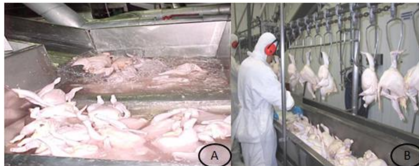
Figura 5: Pré-resfriamento (A) e Gotejamento (B).
