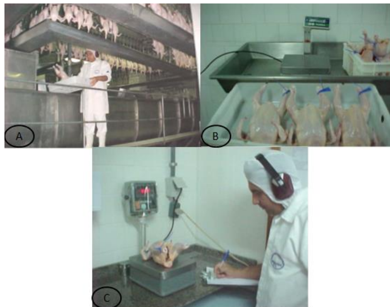
Figura 13: Método do Controle Interno - Retirada da carcaça antes do pré-chiller (A); Lacração das carcaças (B); Pesagem das carcaças (C).
