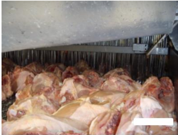
Figura 15: Máquina injetora de salmoura. Fonte: BARRADAS (2010).
