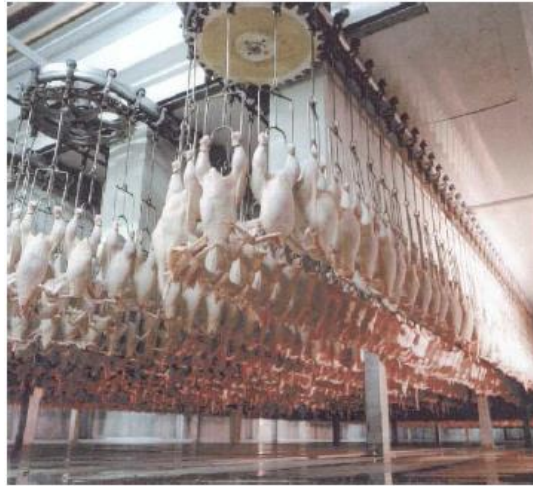
Figura 10: Pré-resfriamento de carcaça de frango por ar frio. Fonte: KLASSEN (2008).
